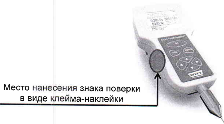
Рисунок А.1 - Схема пломбировки газоанализаторов
